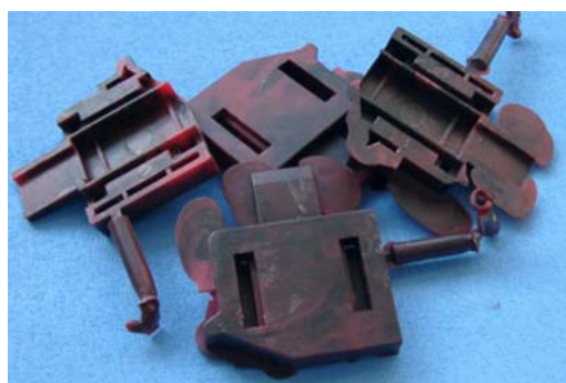
Bilder 3 und 4: Form und Kunststoffteile mit Trennebenenversatz
