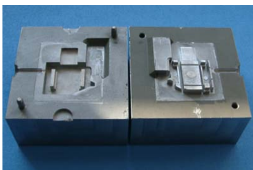
Bilder 3 und 4: Form und Kunststoffteile mit Trennebenenversatz
