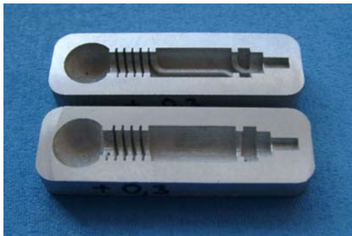
Bilder 1 und 2: Formeinsatz aus Aluminium und abgespritzte Kunststoffteile
