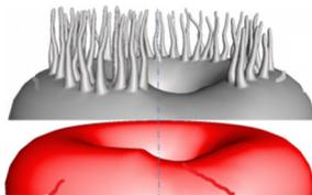
Mit dem Vorhaben *Anti-Rutsch-Folien* aus der *Netzwerkinitiative Dachsicherheit* versuchen wir den aus der Natur bekannten Gecko-Effekt und ähnliche Oberflächenstrukturen als gut haftende, aber auch leicht wieder lösbare Verbindungen über Massenfertigungsverfahren wie Spritzguss herzustellen.
