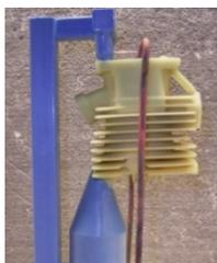
Das Projekt beschäftigt sich mit Optimierungen von Formstoffen oder temperierenden Kühlsysteme in Formen des Feingusses zur Beeinflussung des Erstarrungsverhaltens und damit der Beeinflussung beim Metallguss durch Formstoffdotierungen und zusätzliche Kühlkomponenten im Vakuum-Differenzdruckverfahren
